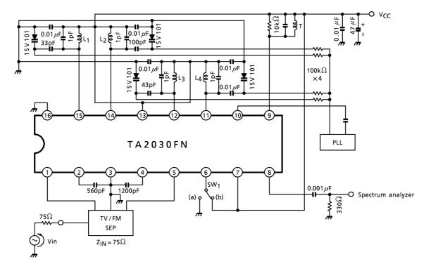
$$\begin{split} &G_C(dB)=20 log~V_{IF}(\mu V_{rms})-(V_{in}(dB\mu V~EMF)-6dB)\\ &TV~/~FM~Separator:~GTVS05(SOSHIN~ELECTRIC~CO.,~LTD.) \end{split}$$
